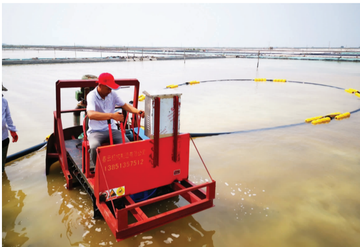
日前,台北海州湾公司海滨工区3组7单元1号盐池新型机械钙盐生产试验圆满成功。据悉该机器在钙盐扒盐中使用属于首创,将会大幅度降低扒盐成本,同时也减少人力的投入。
